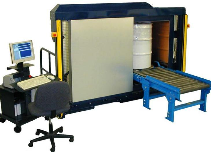
**-Коррекция за поглощение обеспечивается подвижным источником Se-75 для определения 3D пространственного распределения коэффициента поглощения в образце.**
