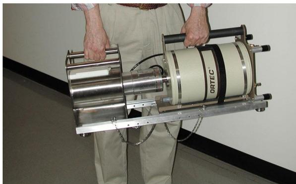
Сборку детектор коллиматор можно снять для измерения в труднодоступных местах
